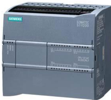
Fig. 16. S7-1200 CPU 1214C. Font: veure referència [15].
