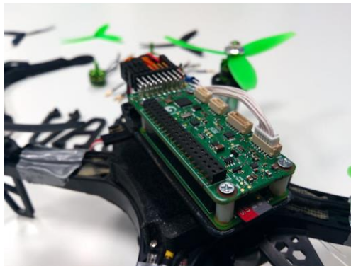
Fig. 7: Dron controlat per una Raspberry Pi Zero. Font: veure referència [29].
