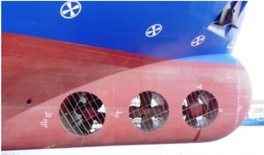
Il·lustració 5. Hélix de proa d'una embarcació (Wikipedia, Hélice de maniobra, 2023)
