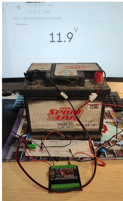
Il·lustració 12. Comprovació de la connexió del ESP32, la comunicació amb Blynk i la lectura del voltatge.
