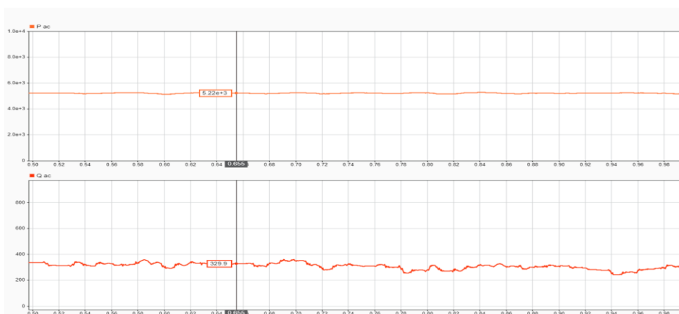
Figura 10-5: Potència activa i reactiva en condicions nominals, mesurada mitjançant les eines de Simulink
