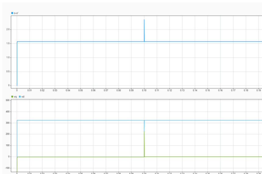
Figura 8-8: Seguiment d'angle i resposta de Vd Vq d'un PLL en quadratura
