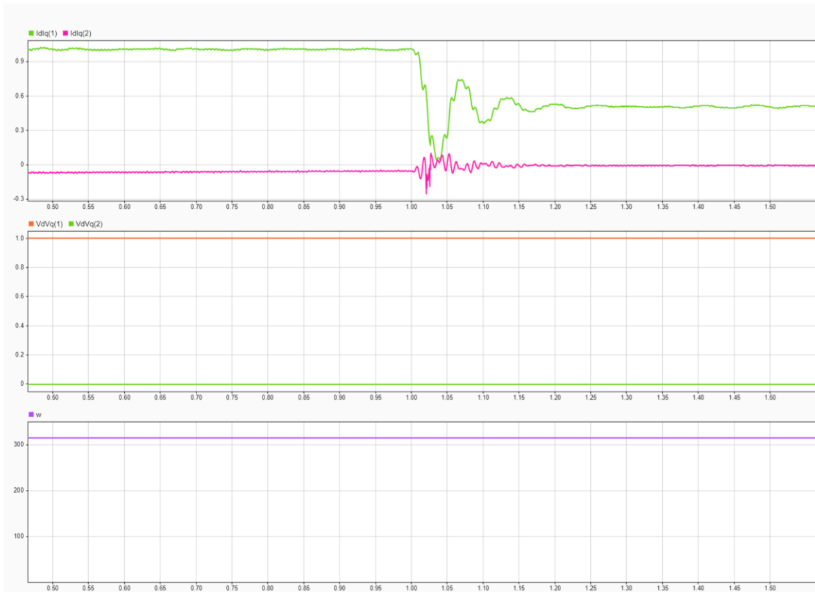
Figura 8-13: Paràmetres I_d , I_q , V_d , V_q i velocitat angular mesurats pel sistema davant una variació de irradiància
