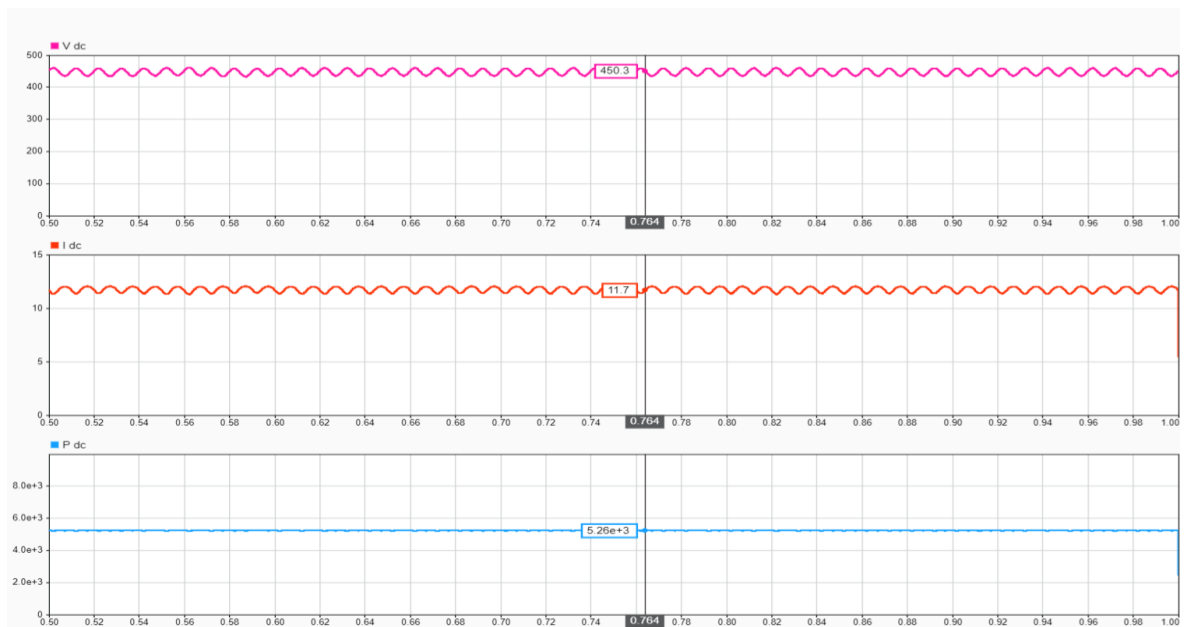
Figura 10-3: Voltatge, corrent i potència d'entrada de l'inversor en condicions nominals
