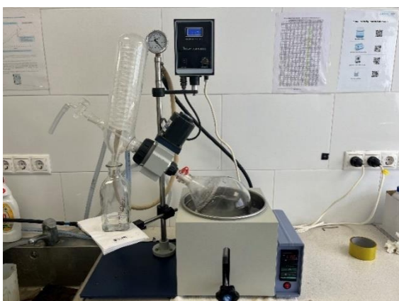
Il·lustració 20: Evaporació de la mostra d'aigua fins a residu sec
