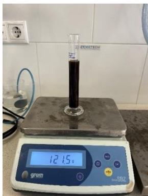
Il·lustració 12: Mesura de la proveta amb l'aigua residual amb presència d'olis (A)
