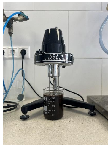
Il·lustració 10: Mesura de viscositat de l'aigua amb olis (B)
