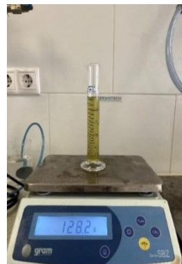
Il·lustració 13: Mesura de la proveta amb l'aigua residual de mineria de Riotinto (B)
