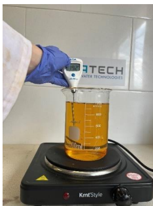
Il·lustració 41: Determinació de l'augment ebulioscòpic
