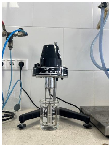
Il·lustració 9: Mesura de viscositat de l'aigua destil·lada (A)
