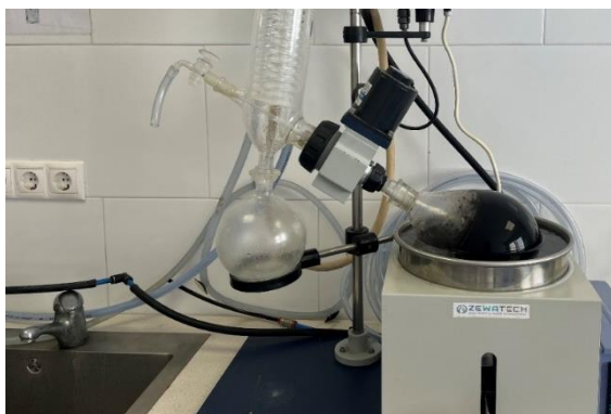
Il·lustració 16: Evaporació de la mostra d'aigua fins a residu sec
