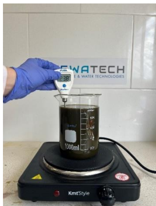
Il·lustració 26: Anàlisi de l'augment ebullescòpic d'una mostra d'aigua residual de la mostra A.
