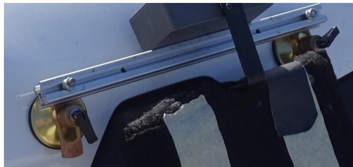
Figura 14. Sistema de ventosas para sujetar la estructura al vehículo
