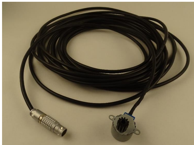
Figura 46. Cable del motor con terminal lemo macho cinco pines
