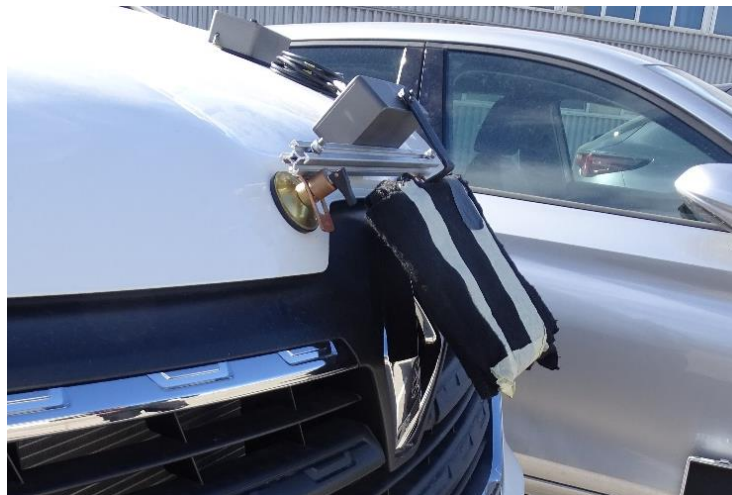
Figura 5. Sistema bloqueo radar visto desde un lateral
