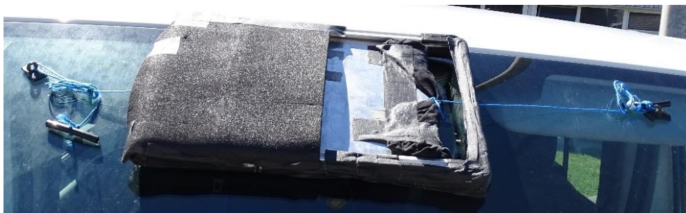
Figura 3. Sistema de bloqueo cámara obstruyendo el sensor
