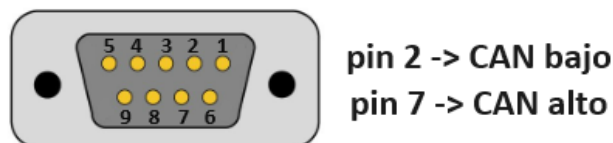
Figura 51. Conexionado conector D-sub nueve pines
