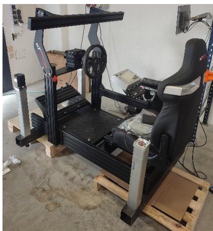
Figura 134. Part superior del xassís muntada amb els actuadors lineals
