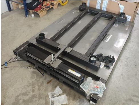
Figura 141. Motor lineal fixat al mòdul amb el sistema de transmissió de moviment
