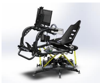
Figura 100. Disseny de sistema de moviment de 6 eixos
