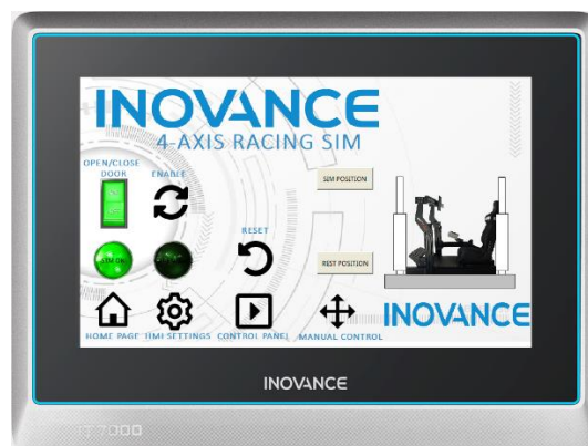
Figura 82. Porta tancada i led de condicions de rearmament encés
