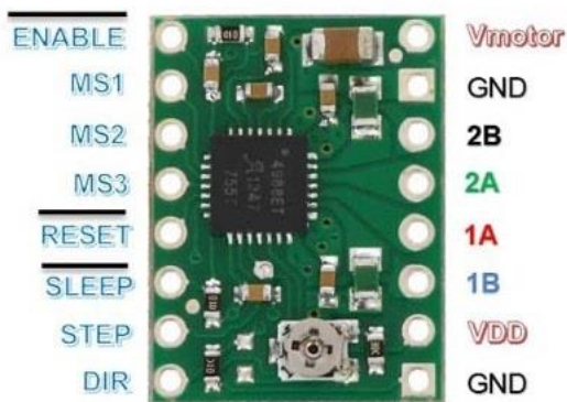
Figura 3.6. Pins driver A4988. [7]
