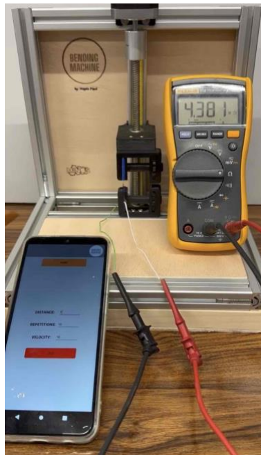
Figura 7.6. Resistència final (4,3 MΩ.) després de 10 repeticions d'1 mm de distància.
