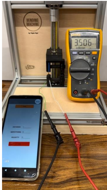
Figura 7.5. Resistència (3,5 MΩ) quan el sensor és sotmès a un esforç de compressió.
