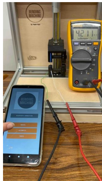
Figura 7.4. Resistència base 4,2 MΩ
