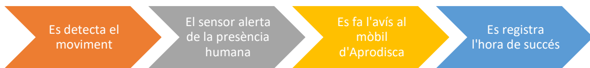
Figura 4: Explicació del funcionament del sistema domòtic
