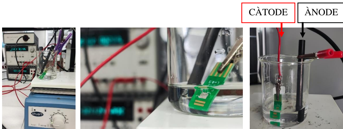
Figura 13. Procés de platinització de la porta.
