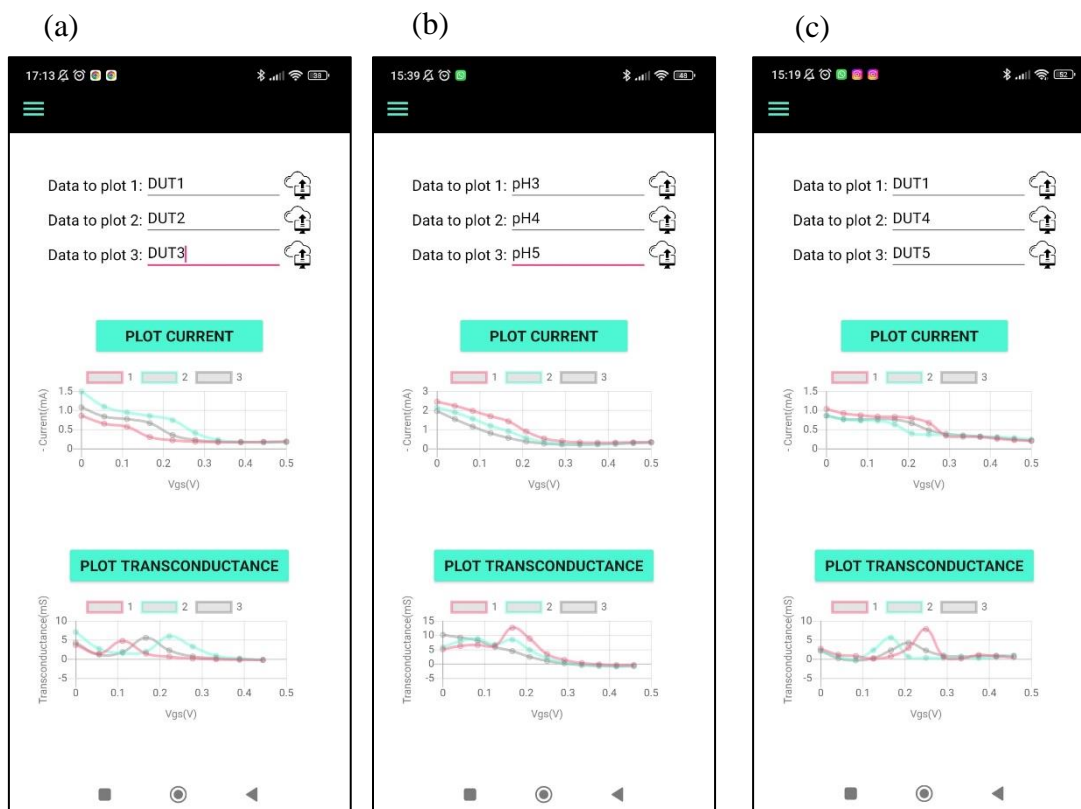
Figura 62. Captures de pantalla de les corbes de transferència i de transconductància per a diferents concentracions i substàncies.
