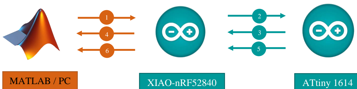
Figura 27. Dibuix esquemàtic de comunicacions entre els dispositius.
