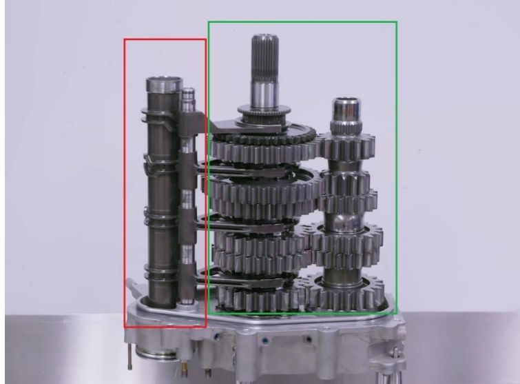
Figura 2.2. Conjunto ensamblado con foco en el tambor ranurado, la conexión a las horquillas y los anillos selectores de las marchas (fuente: Bozi Tatarevic)
