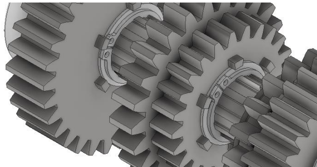
Figura 4.6. Limitaciones de diseño del patrón axial de dientes frontales en base a los elementos de fijación vecinos (fuente: propia)
