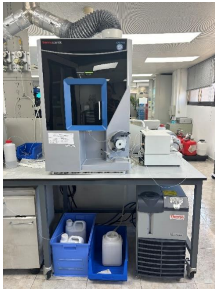
Figura 3. Imatge de l'aparell ICP-OES.
