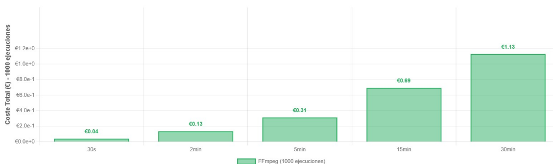
Figura 82. Reducción de ruido de un audio: Coste total variando la duración del video
