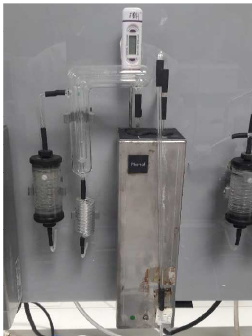
Figura 11. Reactor per a la destil·lació
