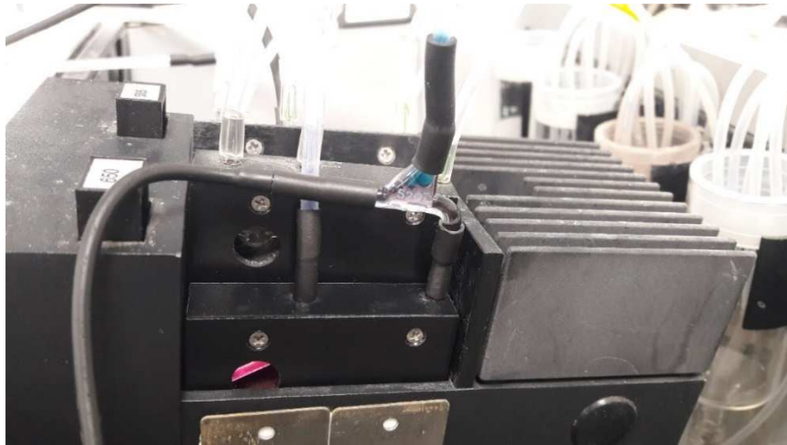
Figura 10. Separador de fases previ a l'entrada de la fase clorofòrmica a la cubeta del detector
