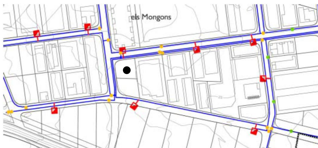
Figura 7. Hidrantes contra incendios en la manzana de la parcela seleccionada
