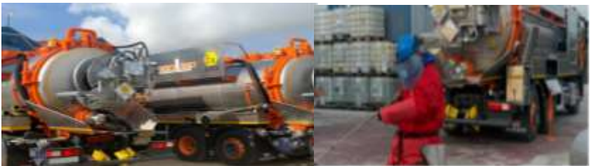
Figura 1. Tecnolimp, (2020). Camiones mixtos ATEX y limpiezas con agua a presión. Recuperado de http://www.tecnolimp.es
