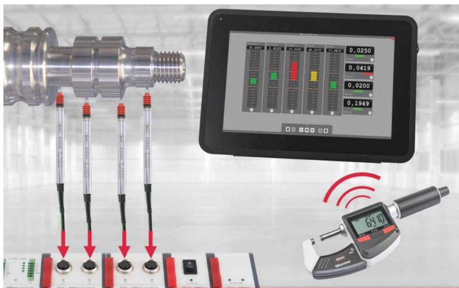
Figura 5.2 Connexionat de les sondes inductives.
