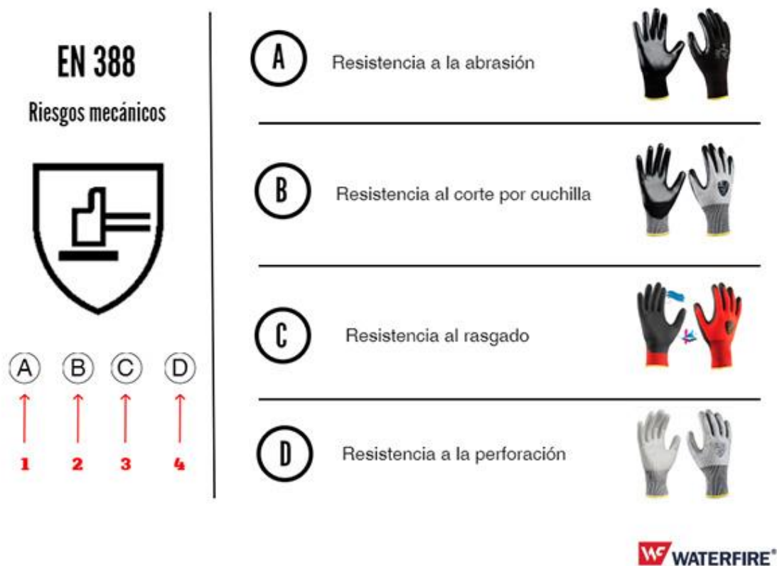
Figura 6.5 Tipologia de resistència dels guants amb protecció mecànica.
