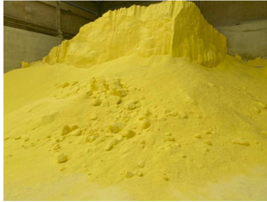
Figura 6. Almacenaje del azufre sublimado producido en las cámaras de sublimación
