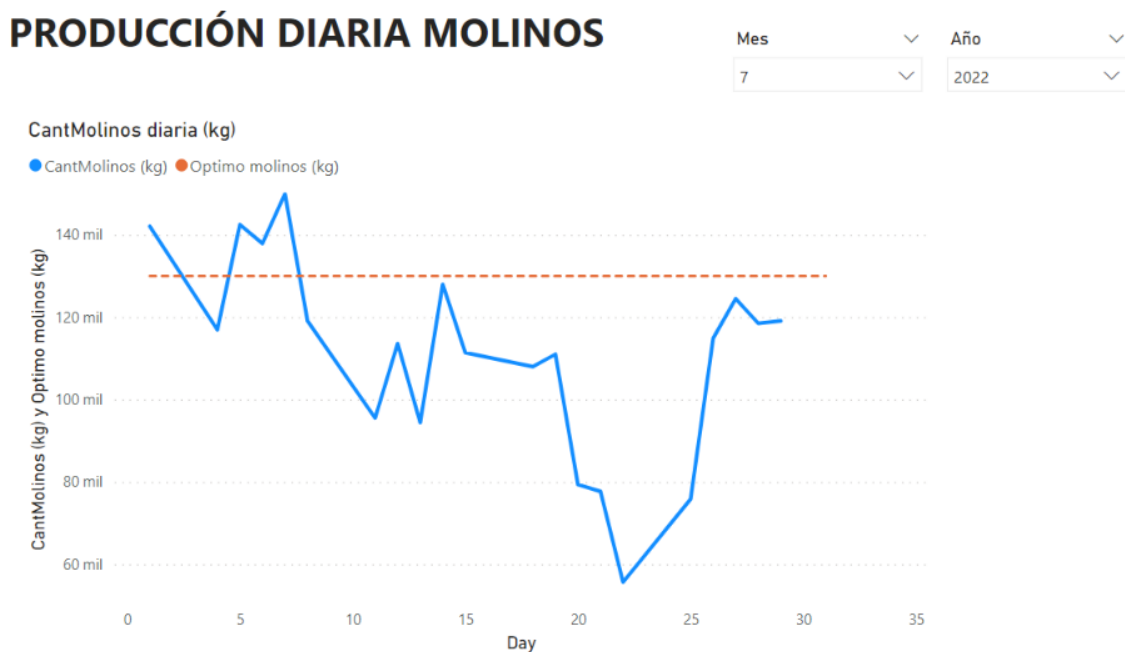
Figura 41. Representación de la producción de los molinos en el mes de julio. Producción real (azul) y producción óptima (naranja)
