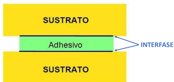
Figura 5. Unión de dos sustratos mediante adhesivo.
