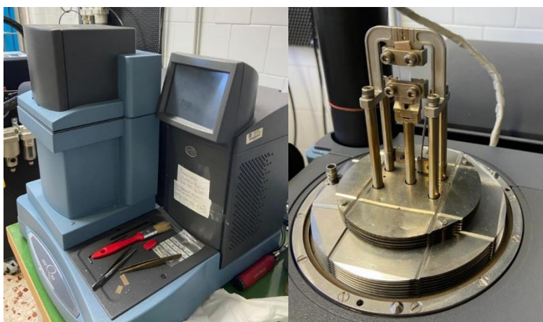
Figura 19. DMTA Q800 (Instrumento TA): equipo (izquierda) y pinza de tensión para la muestra (derecha).
