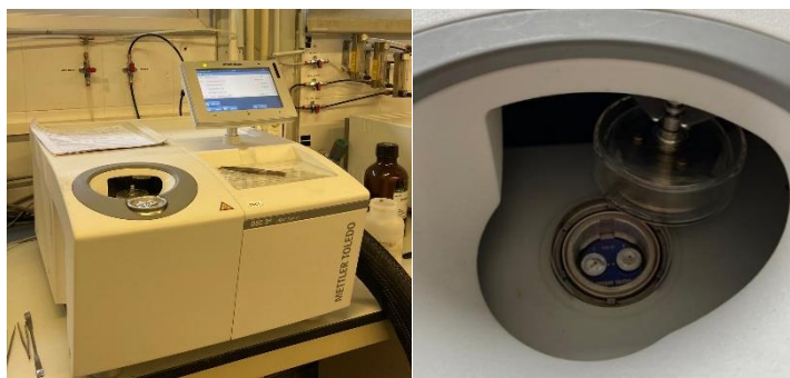
Figura 12. Instrumento DSC-3+ de Mettler Toledo (izquierda) y horno (derecha).
