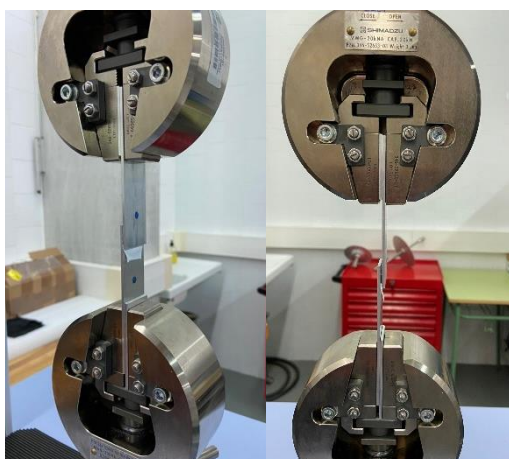
Figura 23. Ensayo lap-shear con la máquina de tracción Shimadzu AGS-X.
