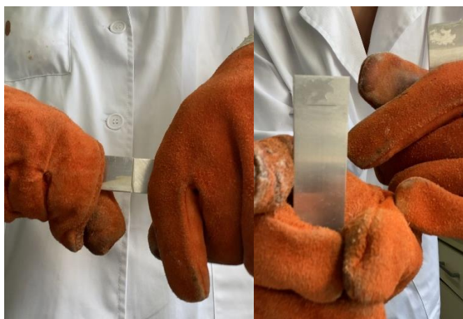
Figura 43. Desmantelamiento manual después de someter dos pletinas adheridas una hora a una temperatura superior a la T_v .
