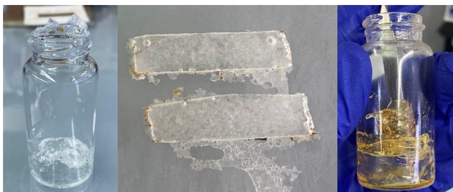
Figura 25. DBU solidificado al mezclar, BG-DBU film no homogéneo y DMAP solidificado al mezclar.
