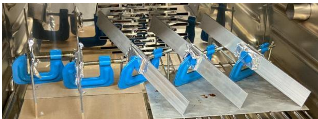
Figura 42. Re-adhesión de pletinas sometidas previamente a ensayo de lap-shear.
