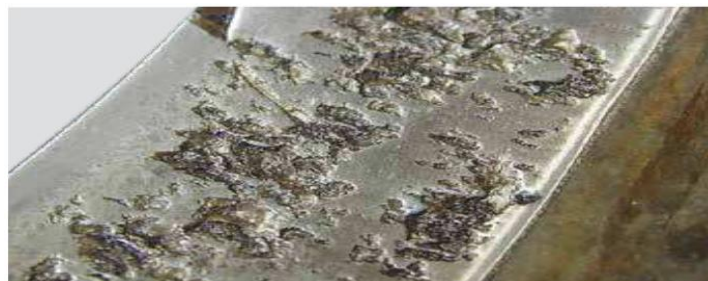
Aro exterior de rodamiento de rodillos a rótula El desgaste abrasivo inicial debido a contaminación se transformó en deformación superficial y descascarillado avanzado
