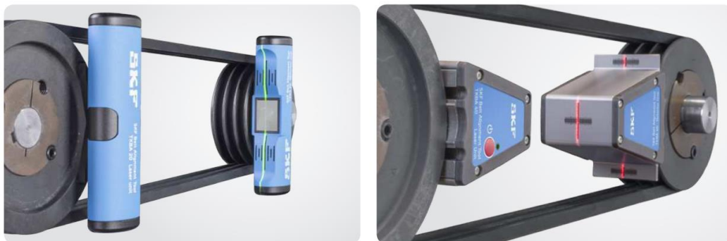
Figura 11.3. Ejemplo de instalación de sensores laser de alineación de poleas [35].
