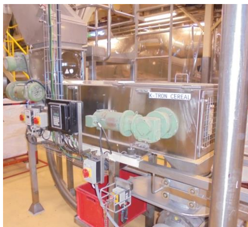
Figura 7.8. El Ktron d'una línia de producció, en aquest cas el de cocció 1.
