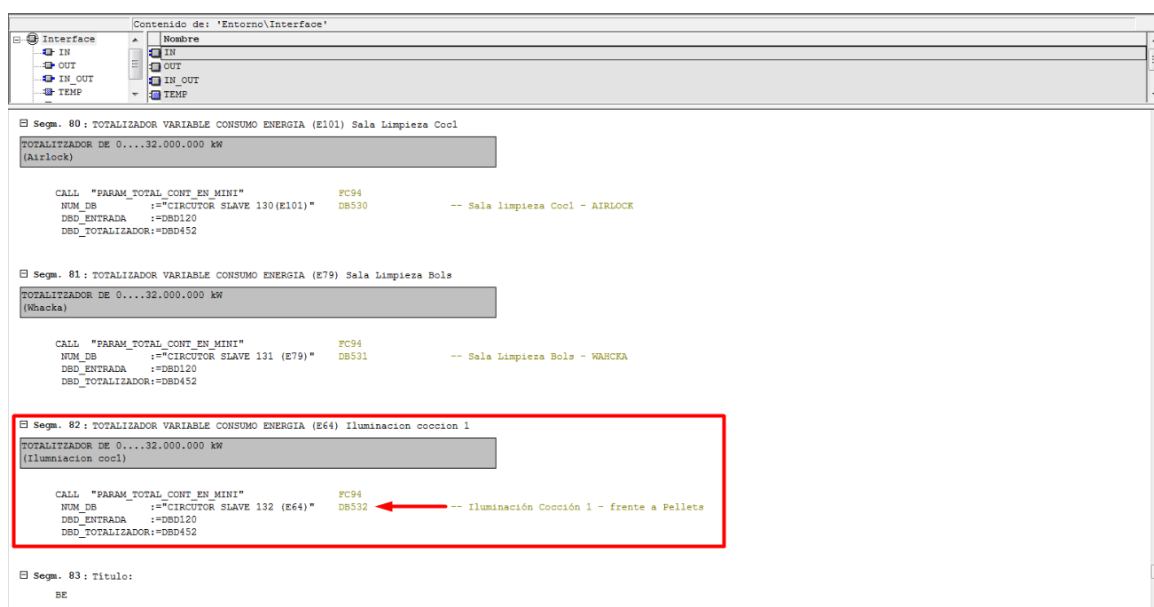
Figura 8.17. Segment 82 afegit per el totalitzador del CVM E64.
