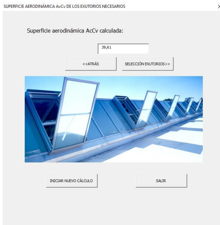
Figura 4.9 Pantalla de resultados superficie aerodinámica opción nave con actividad de almacenamiento.
