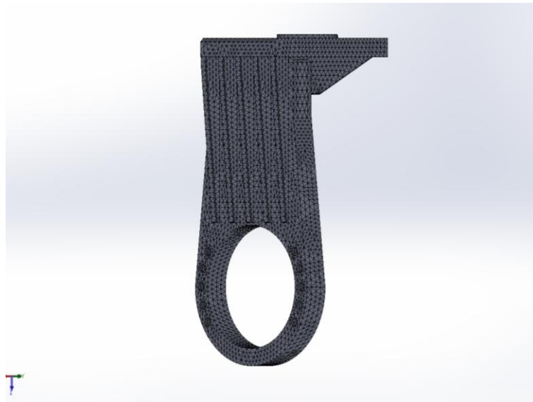
Figura 32. Vista de la malla.
