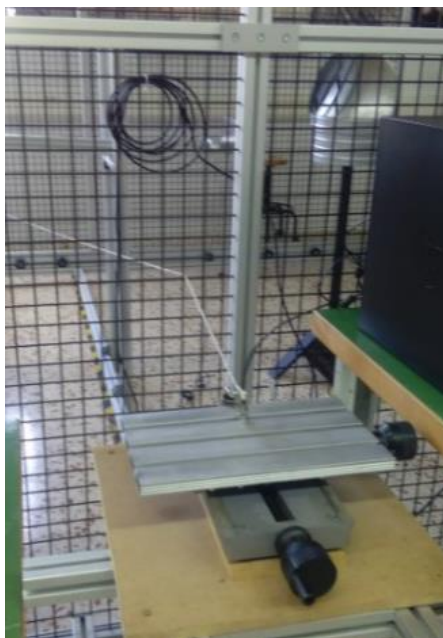
Figura 6.2: Mecanismo regulador de la fuerza de frenado
