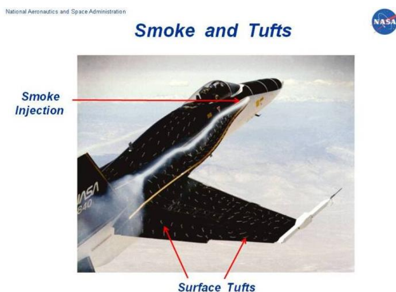
Figura 10.2: Empleo de técnicas con "Tuft" en aeronáutica (Fuente: www.grc.nasa.gov )
