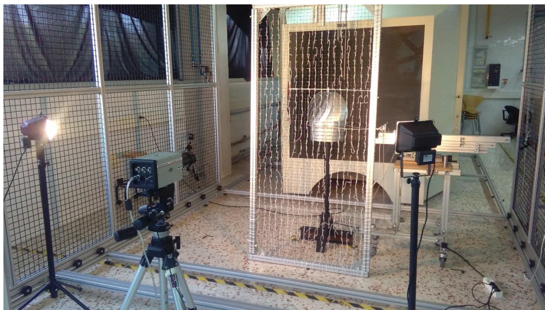
Figura 10.3: Instalación del ensayo frontal metodología Tuft-Grid
