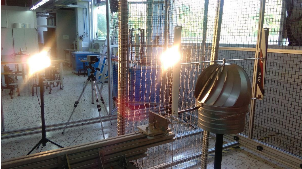
Figura 10.4: Instalación del ensayo posterior metodología Tuft-Grid
