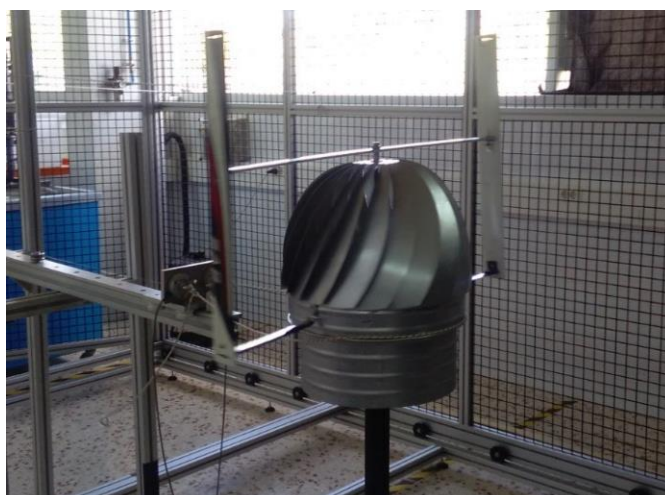
Figura 8.2: Extractor modificado con perfiles de ala NACA-0014
