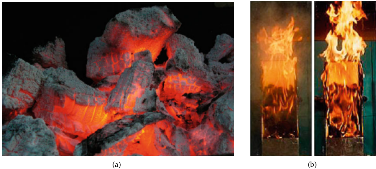
Figura 2.3: Proceso de combustión de la materia sólida - Imágenes ilustrativas de: (a) combustión latente, y (b) combustión con llama [11].
