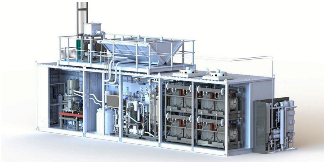
Ilustración 11: Imagen interior del electrolizador de CPH2
