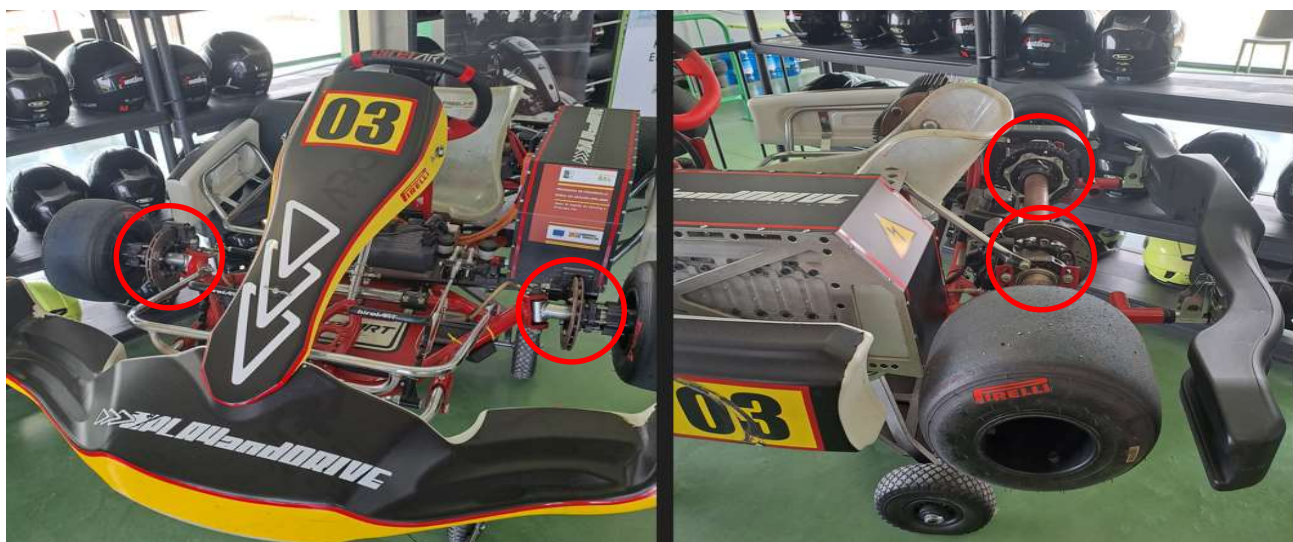
Figura 7.8. Kart de competició: 4 discs de fre. (font pròpia)
