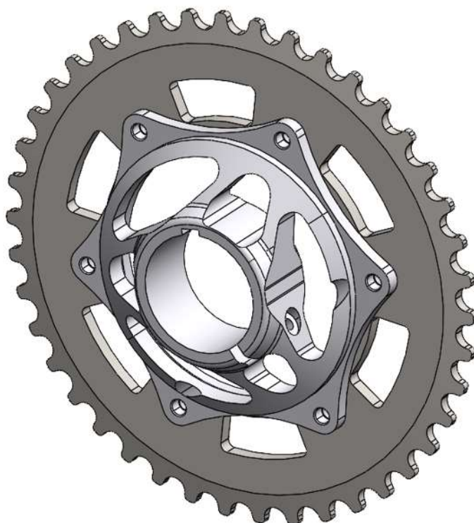
Figura 7.29. Corona amb suport dissenyada pel kart. (font pròpia)
