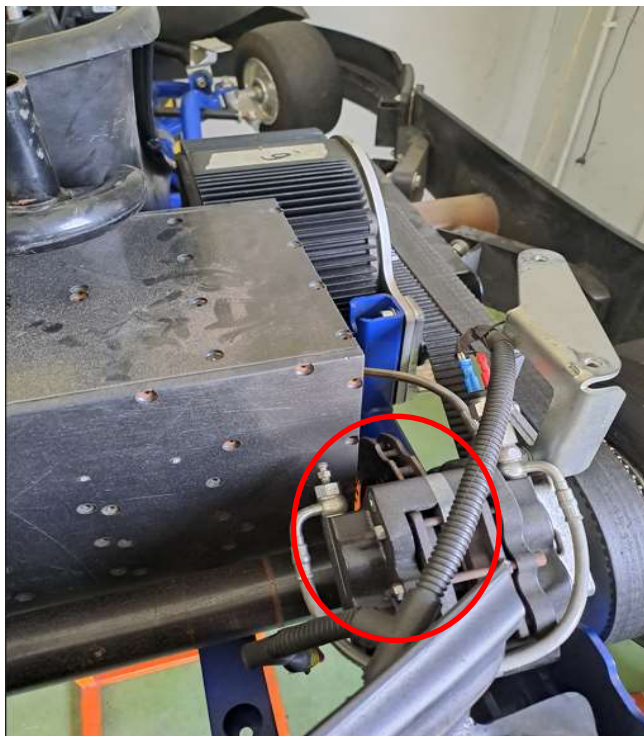
Figura 7.9. Kart d'oci: 1 disc de fre. (font pròpia)
