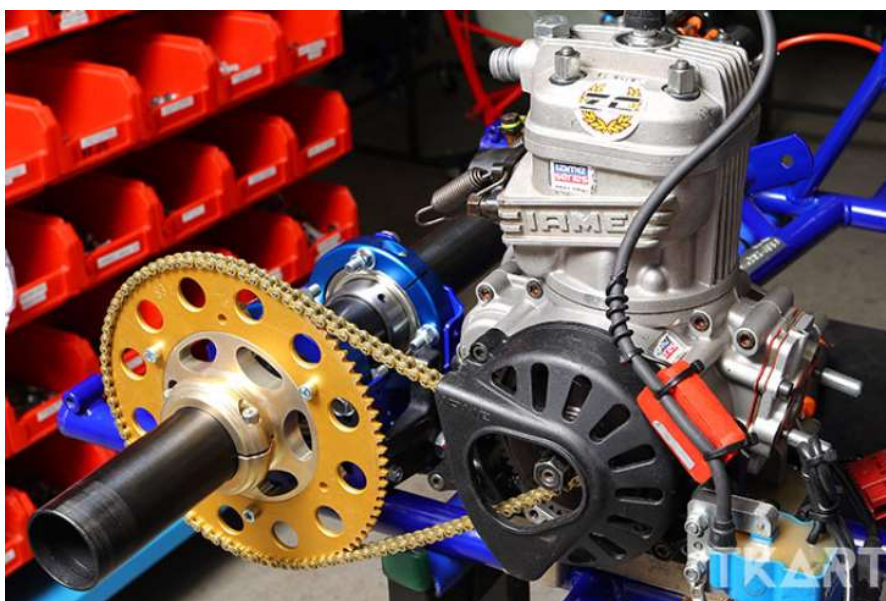
Figura 7.26. Muntatge sistema de transmissió en un kart. (29)
