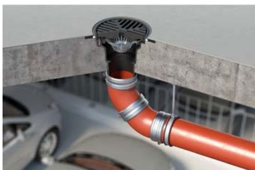
Figura 139. Esquema de l'embornal de l'eix central, connectat amb un baixant de façana
