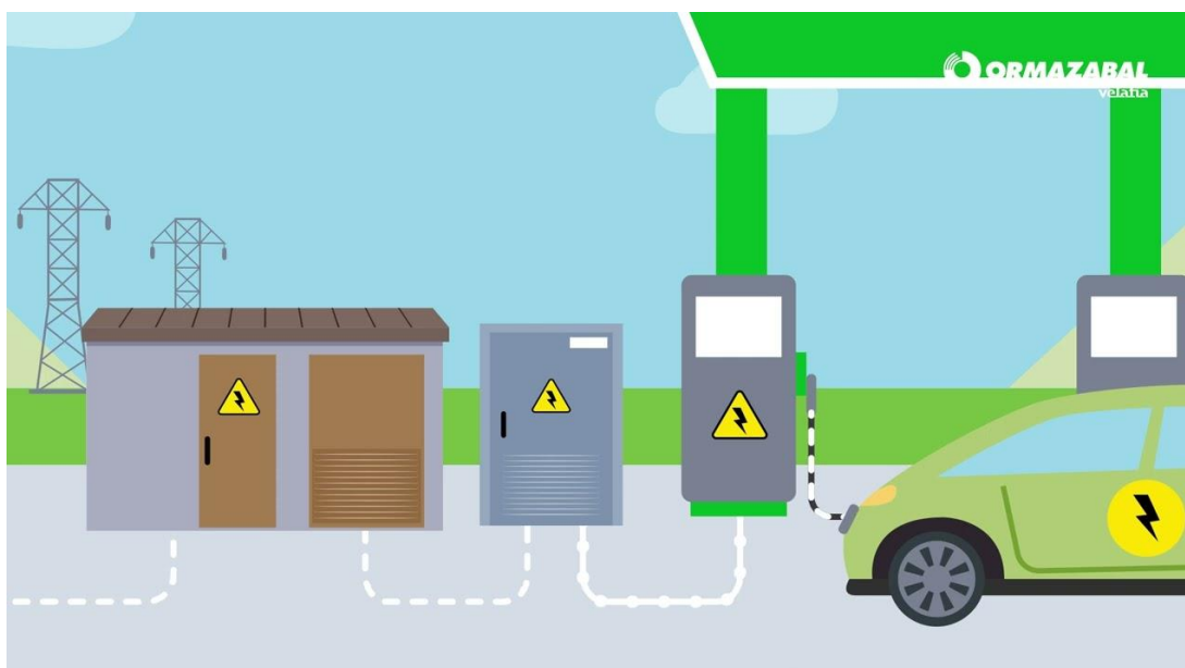
Figura 1. Elementos que forman parte de una electrolinera. De izquierda a derecha se tiene: el centro de seccionamiento y transformación, el convertidor de potencia y el poste de carga. Fuente: Velatia [5]
