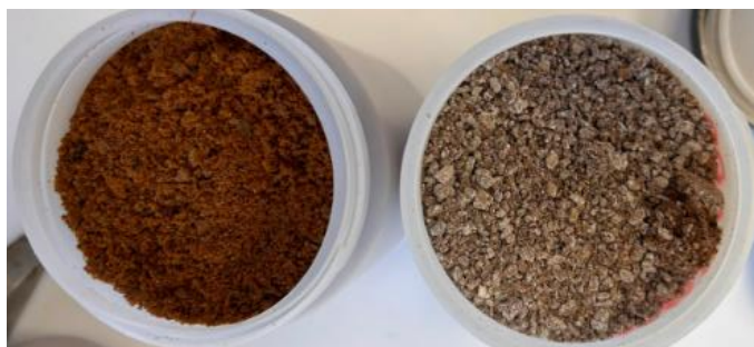
Fig. 3 Diferència de tamany després de la trituració entre els grànuls d'Ascó 1 Belona (esquerra) i Riudoms Vairo (dreta)
