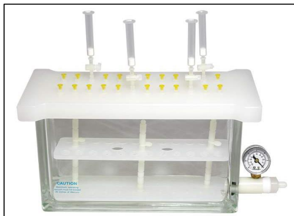
Figura 5. Sistema vacuum manifold usado para SPE.
