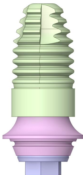
Fig. 16 Detalle geometría implante 10 mm
