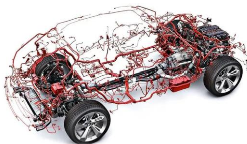
Figura 4. Ejemplo de cableado de turismo común.
