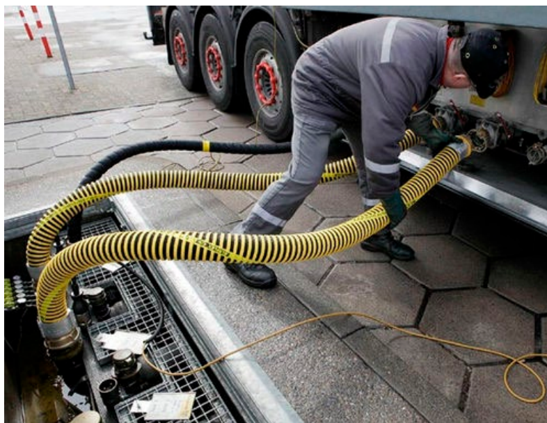
Figura 15: Operario conectando manguera a cisterna.
