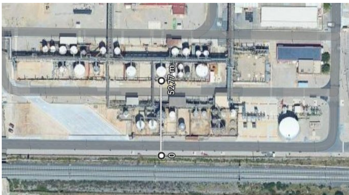
Figura 50: Distancia entre la pared interior del cubeto y el vallado exterior.
