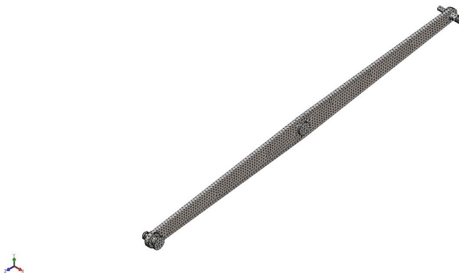
Figura 79. Malla de l'anàlisi estàtica del model TFM020 (SolidWorks Simulation)
