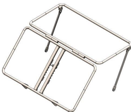
Figura 37. Model d'anàlisi Mecanisme sit-to-stand (SolidWorks Simulation)
