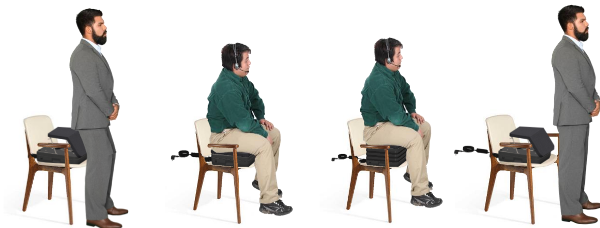
Figura 14. Mockup de l'ús del dispositiu. D'esquerra a dreta. L'usuari està asseient-se. L'usuari es troba completament assegut en la posició inferior de l'elevador. L'usuari es troba completament assegut en la posició superior de l'elevador. L'usuari s'acaba d'aixecar gràcies a l'assistència del mecanisme sit-to-stand .
