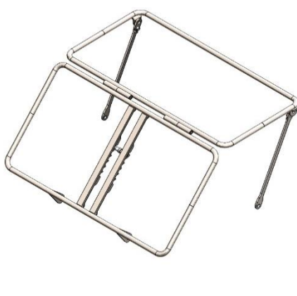
Figura 62. Model d'anàlisi Mecanisme sit-to-stand (SolidWorks Simulation)
