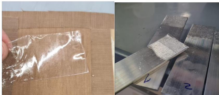
Figura 59. Material intermedi del rati 0.6 amb espessor de 0.2mm (esquerra) i col·locació del mateix sobre la pletina (dreta).
