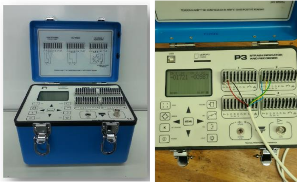
Figura 91. Equip P3 (Vishay Measurements) i connexió \frac{1}{4} de pont amb 3 fils, cada canal representa una deformació (longitudinal o circumferencial).
