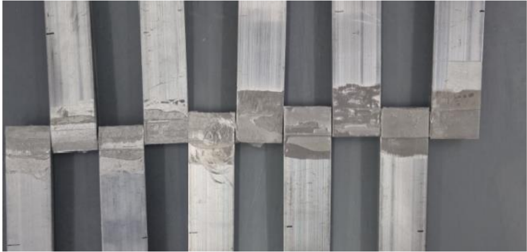
Figura 123. Resultats de les provetes de material amb rati 0.4. S'observa una fallada de tipus mixta que tendeix a adhesiva.
