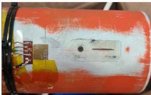
Figura 94. Galga enganxada a la línia d'acció de l'esquerdada.
