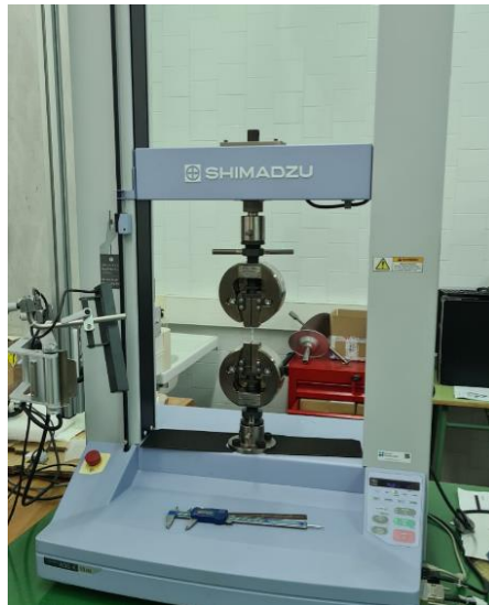
Figura 50. Màquina de tracció Shimadzu AGS-X amb mordasses grans.
