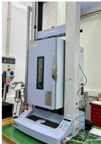
Figura 86. Màquina de tracció amb càmera tèrmica instal·lada.
