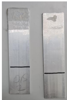
Figura 63. Proveta de material amb rati 0.5 després de ser assajada on es pot observar el tipus de fallada del material.
