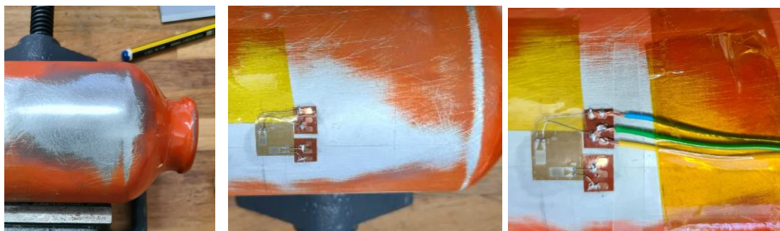
Figura 90. Procediment d'enganxat i connexionat de la galga extensiomètrica.
