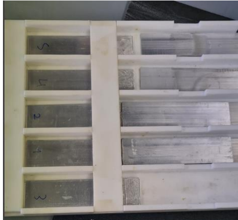
Figura 60. Motlle de tefló utilitzat per assegurar la simetria i alineació de les platines.
