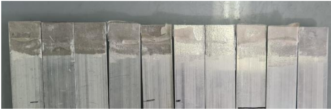
Figura 124. Resultats de les provetes de material amb rati 0.5. S'observa una fallada de tipus mixta que tendeix a adhesiva.
