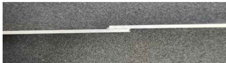
Figura 62. Provetes perfectament alineada i llesta per ser assajada.
