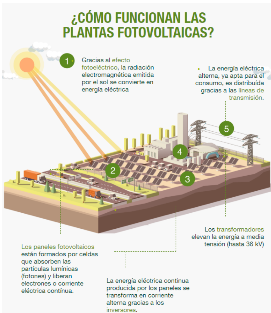
Figura 17. Funcionamiento de una planta fotovoltaica.
