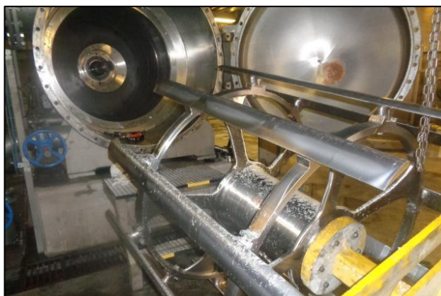
Figura 8. Agitador (en primer plano) y cesta cilíndrica de uno de los depuradores (dentro del equipo). De los archivos de la PM6.
