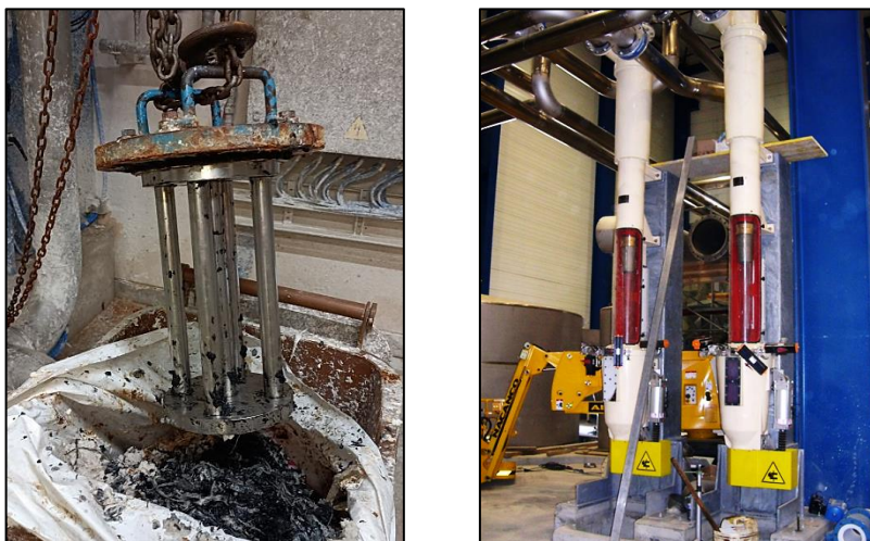
Figura 5. Barras metálicas de los atrapa alambres extraídas de la línea (izquierda, trabajo propio) e hidrociclones de pasta virgen (derecha, referencia [1]).
