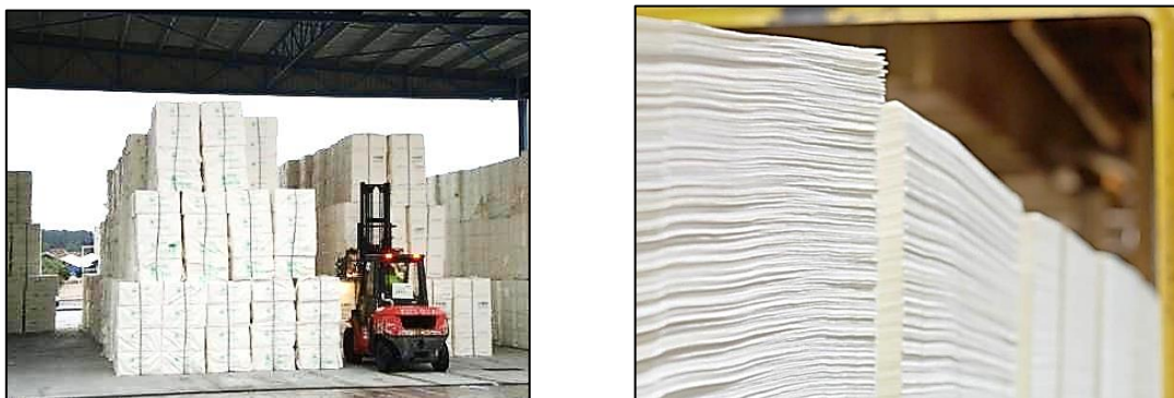
Figura 3. Almacenamiento de balas de celulosa en la planta de Puigpelat (izquierda) y estructura interna laminada de las balas (derecha). De la referencia [1].
