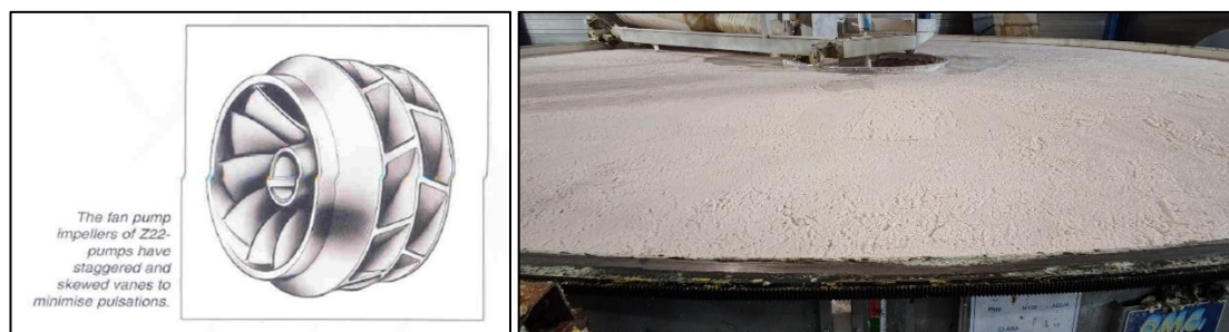
Figura 7. Carrete de las fan pumps instaladas en la PM6 (izquierda, de la referencia [1]) y dispositivo de flotación de fibras (derecha, trabajo propio).
