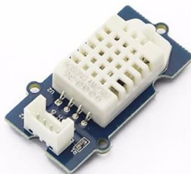
Figura 21. Sensor DHT22 (AM2302) (RS, s. f.).
