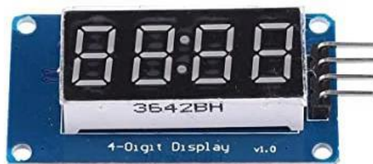
Figura 22. Display de 4 dígitos de 7 segmentos 3642BH.
