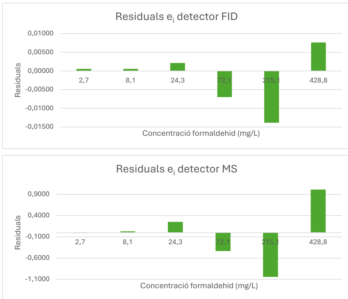
Il·lustració 13. Gràfics dels residuals de les rectes de calibratge per ambdós detectors.
