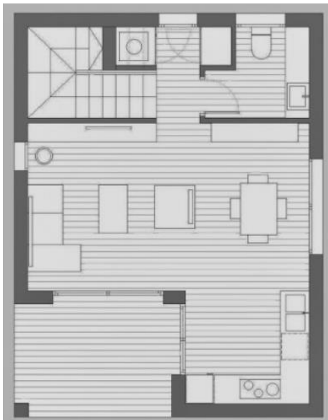
Figura 6. Distribución interna planta baja [22].
