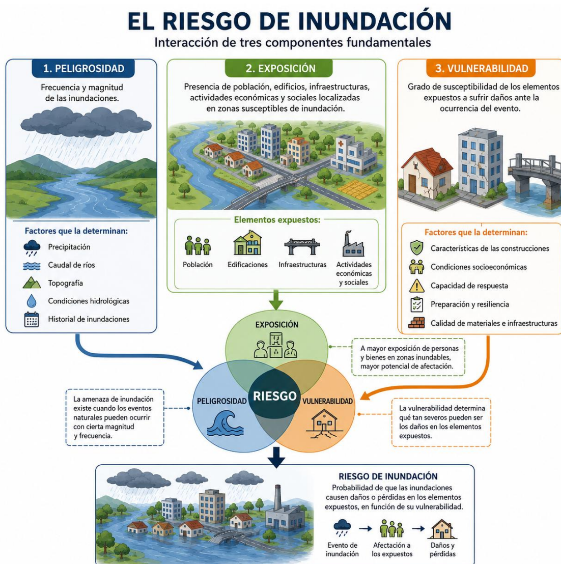
Figura 1. Interacción entre los componentes del riesgo de inundación
