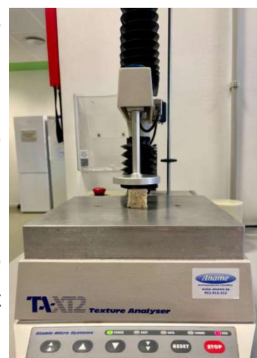
Figura 4. Texturòmetre TA-XT2 analitzant la mostra de pa control (recepta 2).
