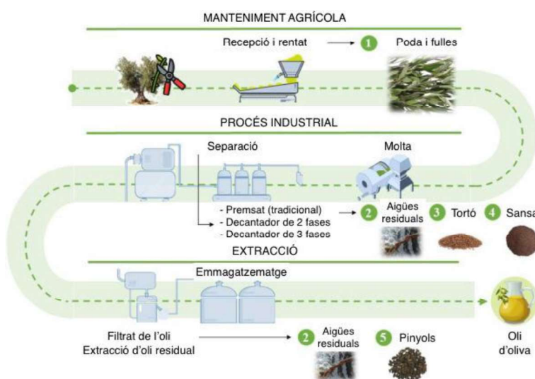
Figura 1. Diagrama de flux de l'extracció d'oli d'oliva i els seus subproductes i residus (adaptada de Otero P. et al. 2021 (2))
