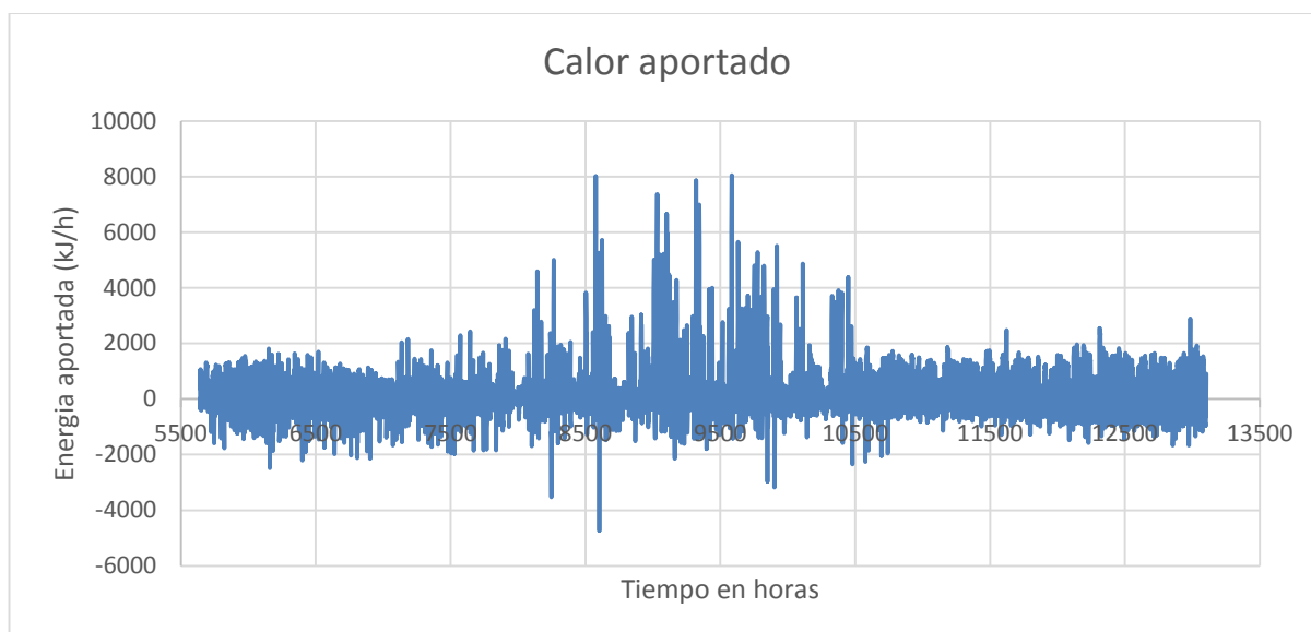
Figura 115. . Calor aportado por las placas de PCM de 9°C a lo largo de la temporada.
