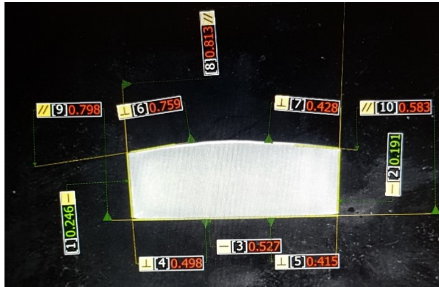
Figura 44. Estudio geométrico. Perfil obtenido mediante PTT 1-modo elevando el caudal de alimentación.
