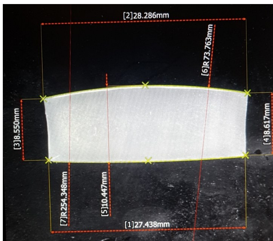
Figura 43. Estudio dimensional. Perfil obtenido mediante PTT 1-modo elevando el caudal de alimentación.
