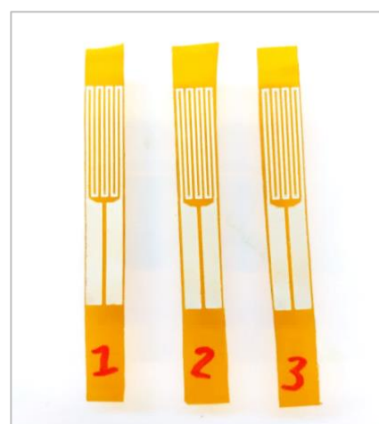
Figura 16. Malla conductora de tinta de plata de 25 μm de espesor impresa sobre una máscara de Kapton de 50 μm.
