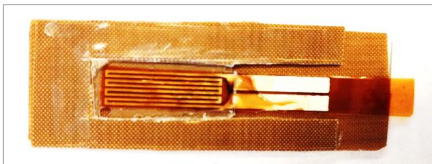
Figura 17. Posicionado de las diferentes capas que constituyen el actuador sobre el molde de teflón.
