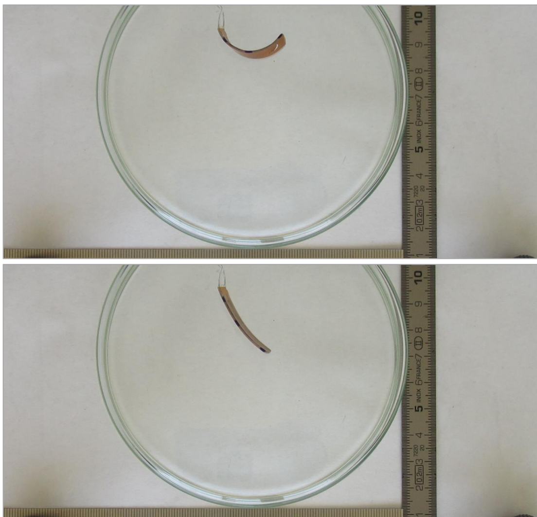
Figura 31. Evolución de la respuesta a la memoria de forma del Actuador-02 durante el desarrollo del Test-06 para una corriente de calefacción I_{HEAT} = 500 \text{ mA} : (a) Imagen del actuador polimérico para t = 0'00'' ; (b) Imagen del actuador polimérico para t = 0'40'' .
