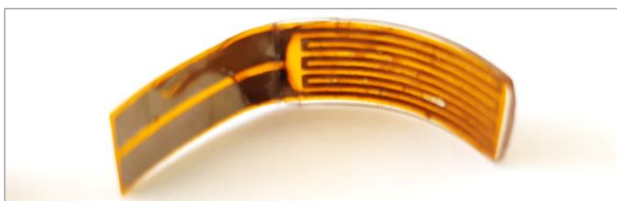
Figura 20. Imagen del actuador polimérico (Actuador-02) ya programado.
