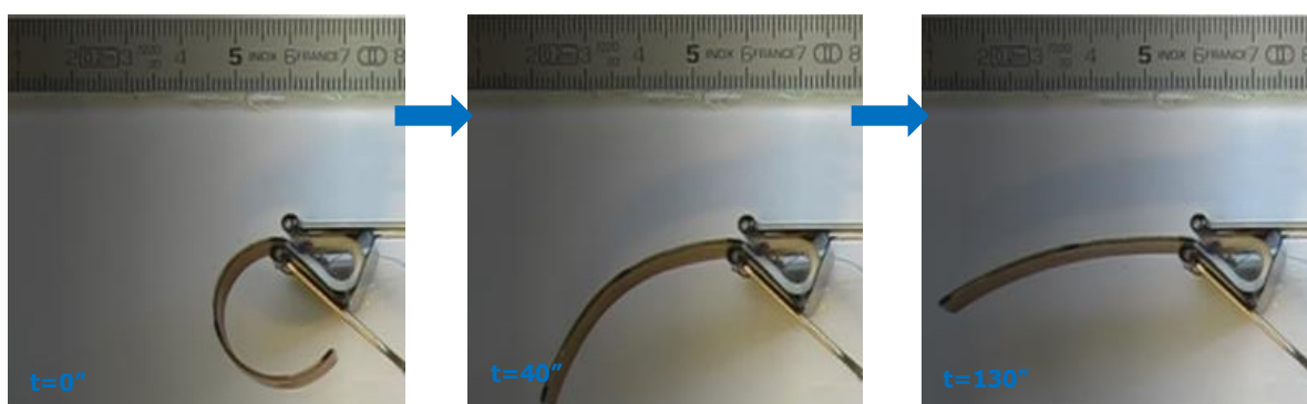
Figura 62. Secuencia de recuperación de forma para la modalidad "normal" ( I_{HEAT} = 333 \text{ mA} ).
