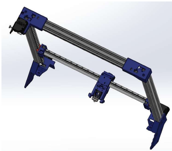
Ilustración C.15 Montaje de la unión del travesaño superior con los componentes que conforman el Core XY.
