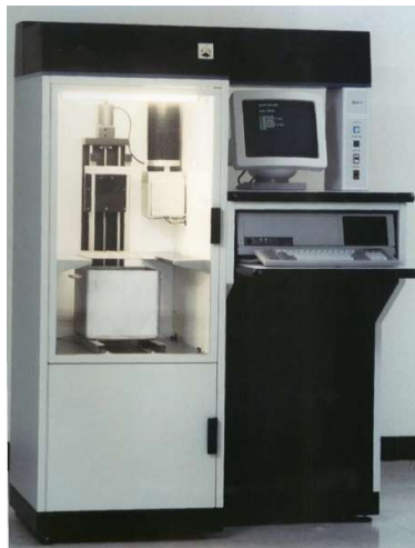
Ilustración 1 SLA-1 la primera impresora 3D de la historia.
