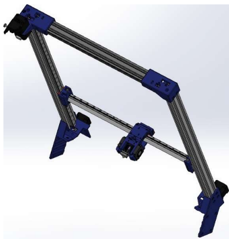
Ilustración C.18 Montaje definitivo del Core XY.
