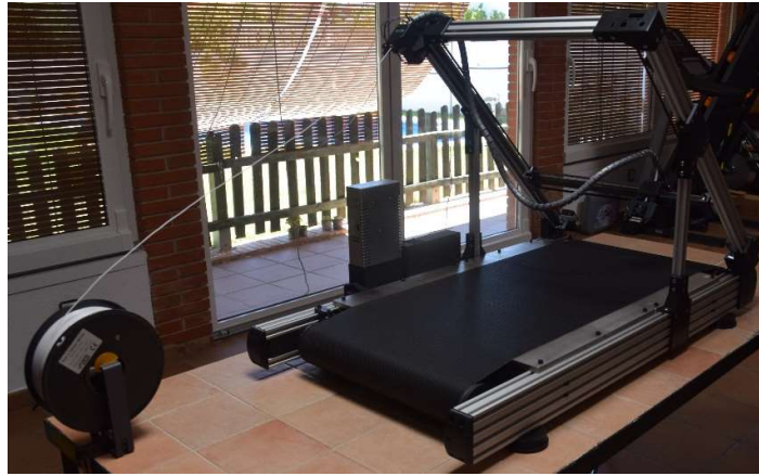
Ilustración 39 Prototipo final de la impresora 3D Core XY de eje infinito.
