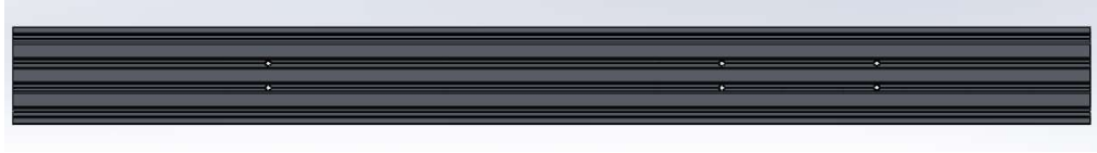
Ilustración C.1 Disposición de las perforaciones en los perfiles 4080C
