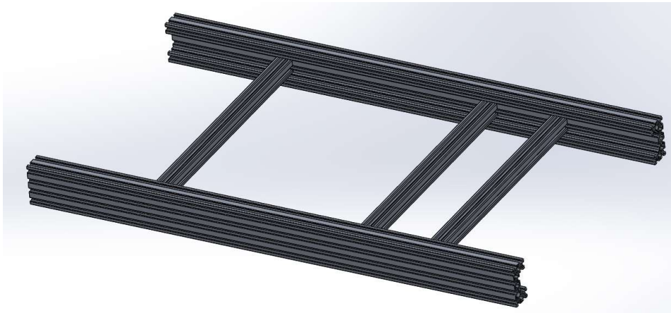
Ilustración C.2 Unión de las piezas que conforman la base de la impresora.
