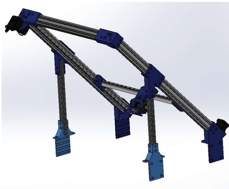
Ilustración C.19 Acoplamiento de los perfiles verticales y anclajes.
