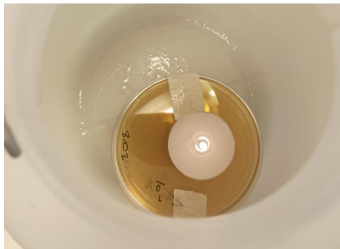
fig.6. Preparació del medi sense oxigen per a la determinació de bacteris anaerobis
