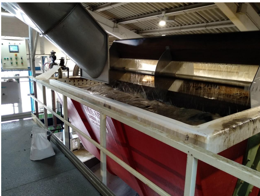
Imagen 4. Vista de un proceso de remojo. Las aspas de la molineta provocan un movimiento continuo de las pieles en su interior.
