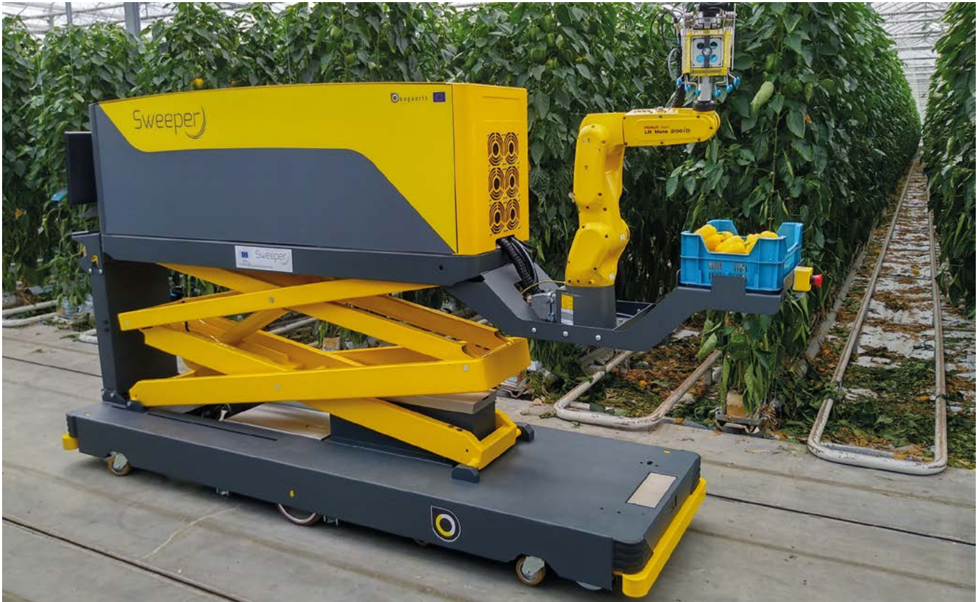
Robot de recol·lecció automàtica d'hortalisses segons el seu grau de maduresa, desenvolupat en el marc del projecte SWEPPER finançat pel programa H2020 de la Unió Europea. Foto: www.sweeper-robot.eu
