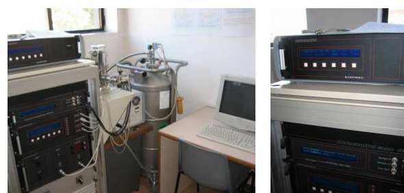
Figura 2. - Equipo DEA utilizado con la unidad de control para fijar los parámetros de la prueba.
